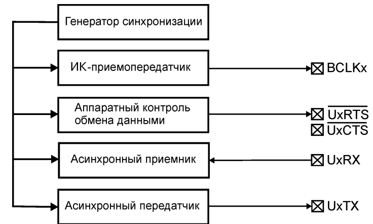
Рис. 10.1. Упрощенная схема модуля асинхронного обмена данными
